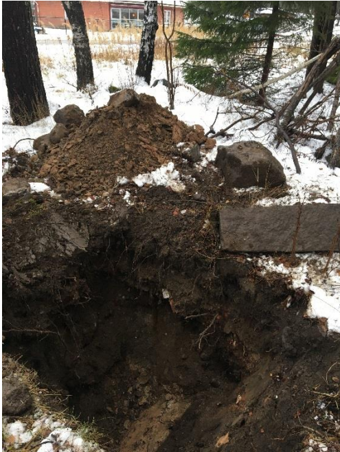
Figur 7 och 8. Bild på provgrop SW17_10 som är belägen på grannfastigheten Surahammar 9:343. Gropen innehåller byggavfall.
