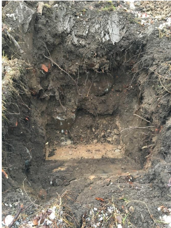
Figur 7 och 8. Bild på provgrop SW17_10 som är belägen på grannfastigheten Surahammar 9:343. Gropen innehåller byggavfall.
