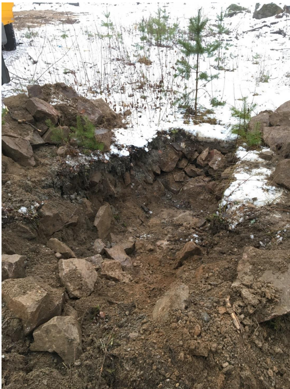
Figur 4. Bild på provgrop SW17_09 där berg låg på ca 0,6 m umy.
