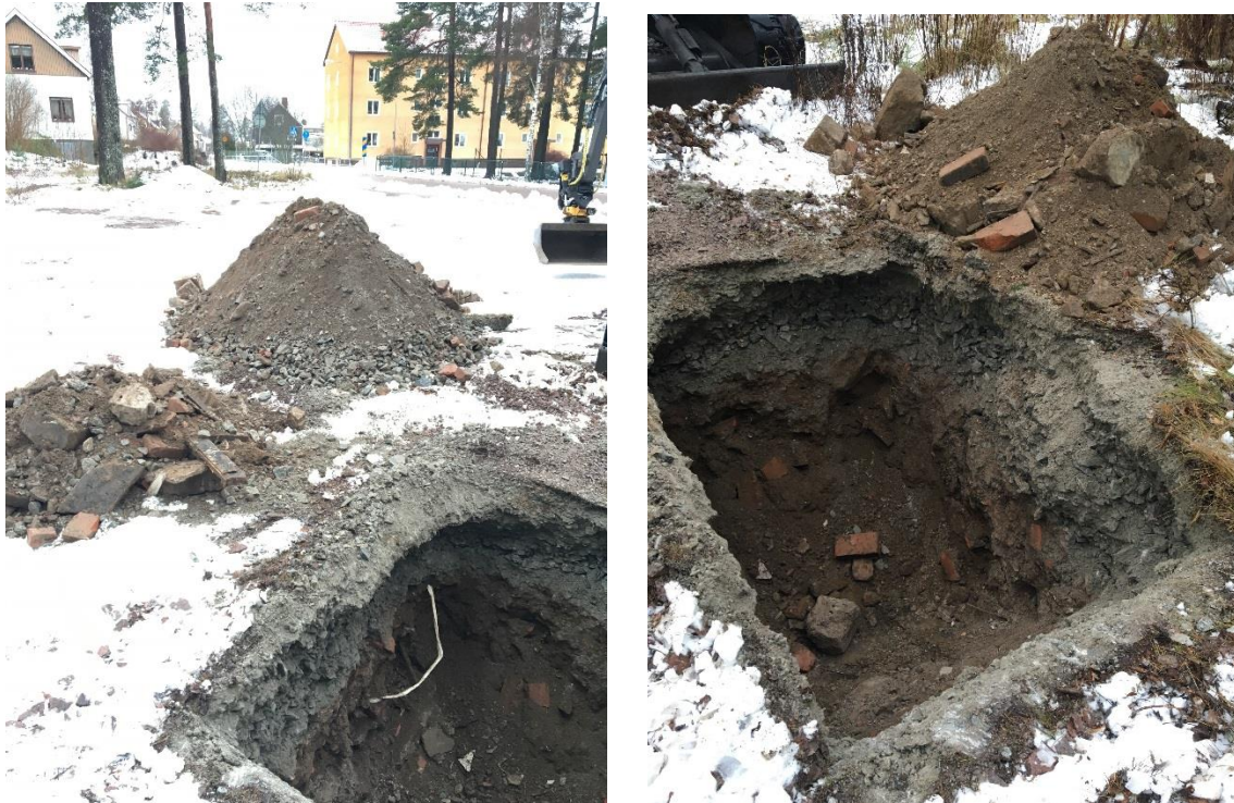
Figur 5 och 6. Bild på provgrop SW17_06. Där syns byggavfall och provgropen liknar i sammansättning de andra provgroparna som gjordes inom rutorna A och B.
